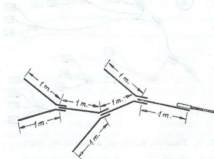
Sl. 22. Mreža za ispitivanje detonirajućeg štapina u pogledu prenošenja detonacije
